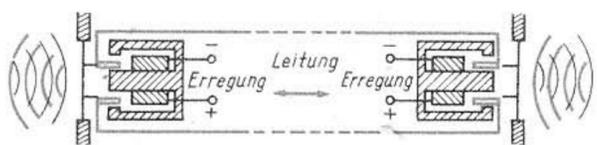
Abb. 3. Siemensches elektrodynamisches Telefon
